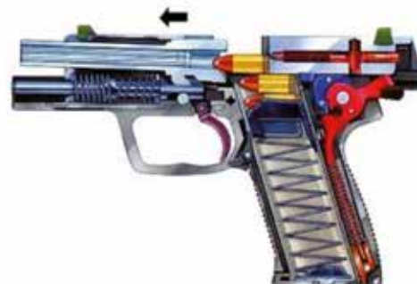
6. Verschluss im Vorlauf, Patrone wird dem Patronenlager zugeführt
