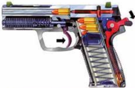
1. Pistole geladen, Sicherungshebel auf „F“, Hahn gespannt
