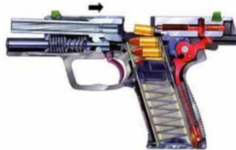
4. Lauf entriegelt, Patronenhülse wird ausgeworfen
