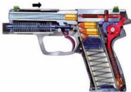
3. Patrone abgefeuert, Verschluss und Lauf sind im Rücklauf beim Entriegeln
